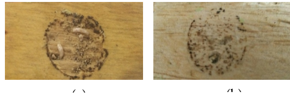
Gambar 3. Penampakan kerusakan pada (a) kayu jabon dan (b) sengon setelah pengumpanan rayap kayu kering
