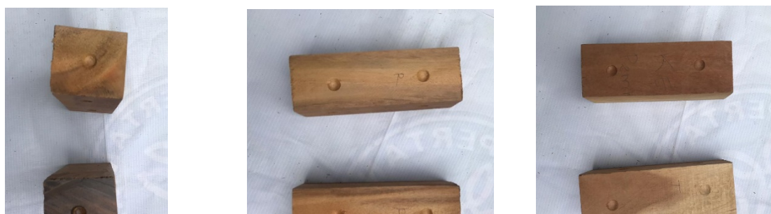
Gambar 2. Kerusakan pengujian kekerasan pada bidang aksial (a), radial (b), dan tangensial (c)
